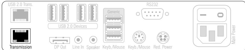
**Transmission:** Stecken Sie ein als Zubehör erhältliches Twisted-Pair-Kabel der Kategorie 5e (oder höher) ein. Das andere Ende des Kabels ist mit der entsprechenden Schnittstelle des Rechnermoduls oder einem *DynamicPort* eines kompatiblen Matrixswitches (s. Seite 5) zu verbinden zu verbinden.
