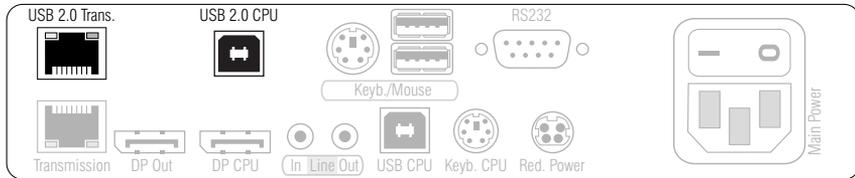
**USB 2.0 CPU:** Verbinden Sie eine USB-Schnittstelle des Rechners mit dieser Schnittstelle. Verwenden Sie hierzu das Kabel *USB-AM/BM-2*.
