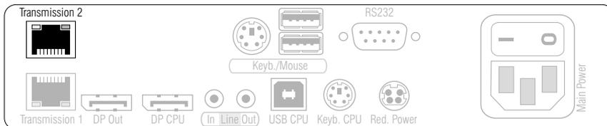
**Transmission 2:** Stecken Sie ein als Zubehör erhältliches Twisted-Pair-Kabel der Kategorie 5e (oder höher) ein. Das andere Ende des Kabels ist mit der *Transmission*-Schnittstelle eines kompatiblen Rechnermoduls oder eines Matrixswitches zu verbinden.
