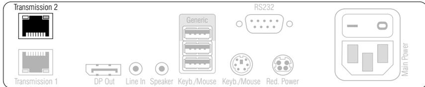
**Transmission 2:** Stecken Sie ein als Zubehör erhältliches Twisted-Pair-Kabel der Kategorie 5e (oder höher) ein. Das andere Ende des Kabels ist mit der *Transmission*-Schnittstelle eines kompatiblen Rechnermoduls oder eines Matrixswitches zu verbinden.
