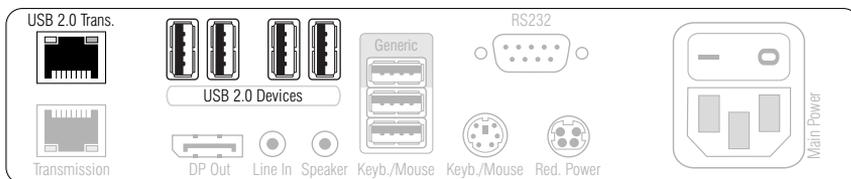
**USB 2.0 Devices:** An diese Schnittstellen – zwei befinden sich an der Rückseite und zwei weitere an der Frontseite des Geräts – können beliebige USB-Geräte angeschlossen werden.
